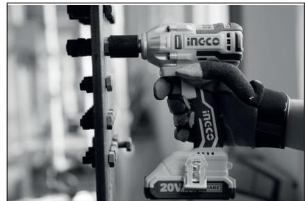
1. Segure firmemente a ferramenta e coloque a chave de caixa o parafuso. Ligue a ferramenta e aperte pelo tempo adequado.
