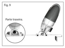
**Nota:** Parater folga suficiente ou um bom aperto da base, pode ser necessário girar a alavanca repetidamente quando desapertar ou apertar o parafuso de ajuste do ângulo. A alavanca tem um sistema de engate / desengate. Puxe a alavanca para trás para desengatar e para a frente para engatar, aperte ou desaperte o parafuso conforme necessário. Ver a figura 10.
