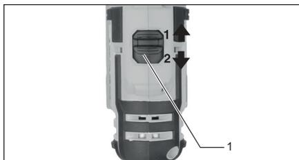
**Cuidado!** Ajuste a alavanca de mudança de velocidade para a posição correta. Se operar com a alavanca de mudança de velocidade mal posicionada, a meio caminho, entre o lado "1" e o "2", o motor poderá sofrer sérios danos.
