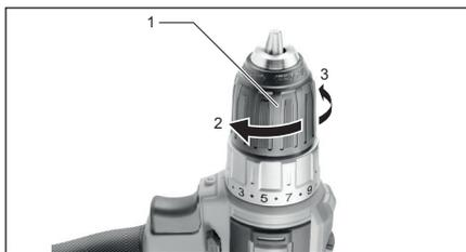
1. Para instalar uma broca ou bit no berbequim aparafusador, gire a bucha no sentido contrário aos ponteiros do relógio para abrir o bocal e de seguida coloque o acessório pretendido.
